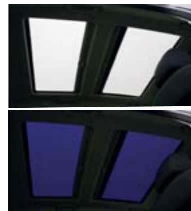
車のルーフガラスに採用された Pilkington Sundym Select™。ボタンひとつでクリア(上)から濃色(下)モードに瞬時に変えることができます。
